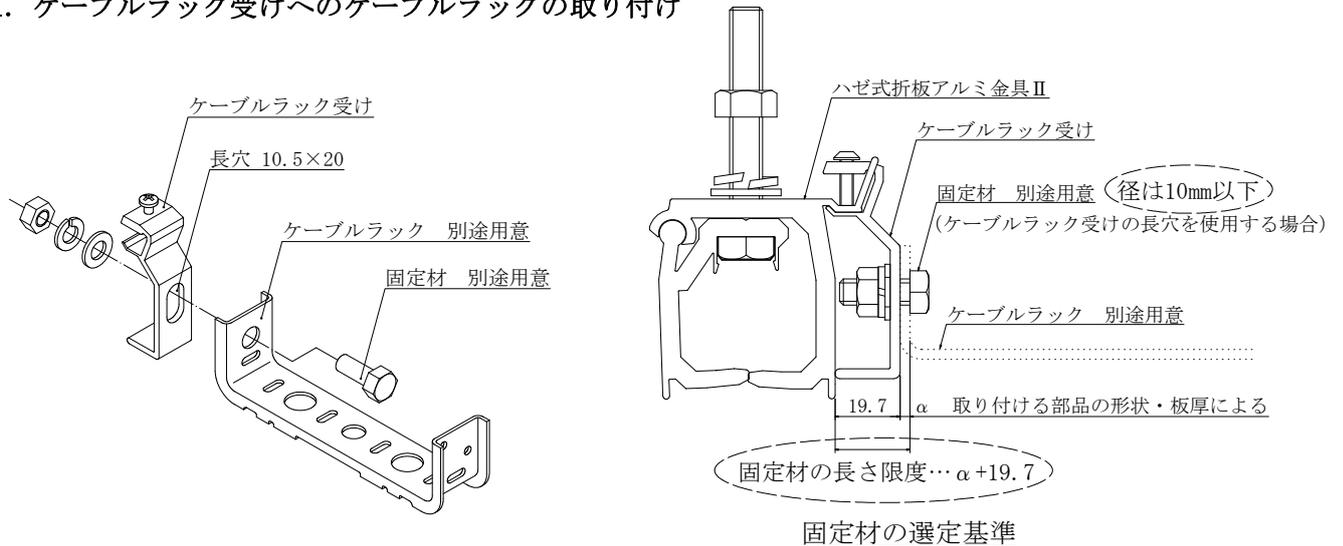
**⚠ 注意** 別途用意部材の取り付け方法・使用条件は、メーカーの発行するカタログ・施工要領書等に従ってください。(例：上図はネグロス電工製 SD-PVBR125 ケーブル支持金具)
