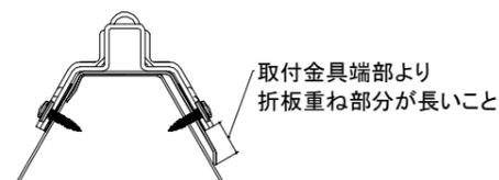
重ね式折板取付金具を墨出し位置に合わせて置き、専用ジグを介して踏みつけながら取付金具の側面にある穴を使用しトルネードポイントビスにて計4箇所固定してください。
